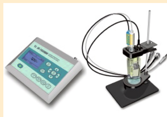
Лабораторный иономер И-160 предназначен для измерения характеристик воды и водных растворов
